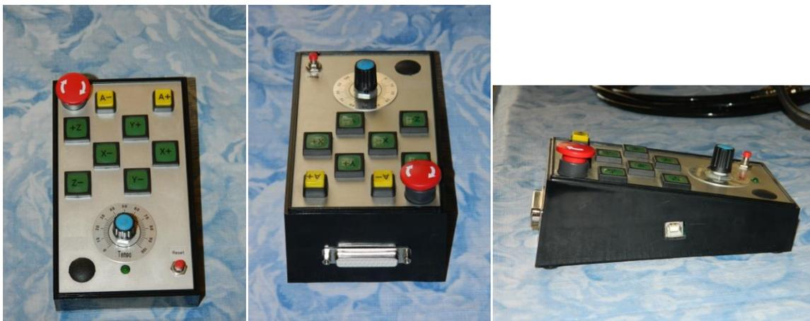
Eingebaute Karte von [www.planet-cnc.com](http://www.planet-cnc.com) Mk1 (4 axis)
